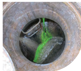
Repérage des eaux parasites par coloration
